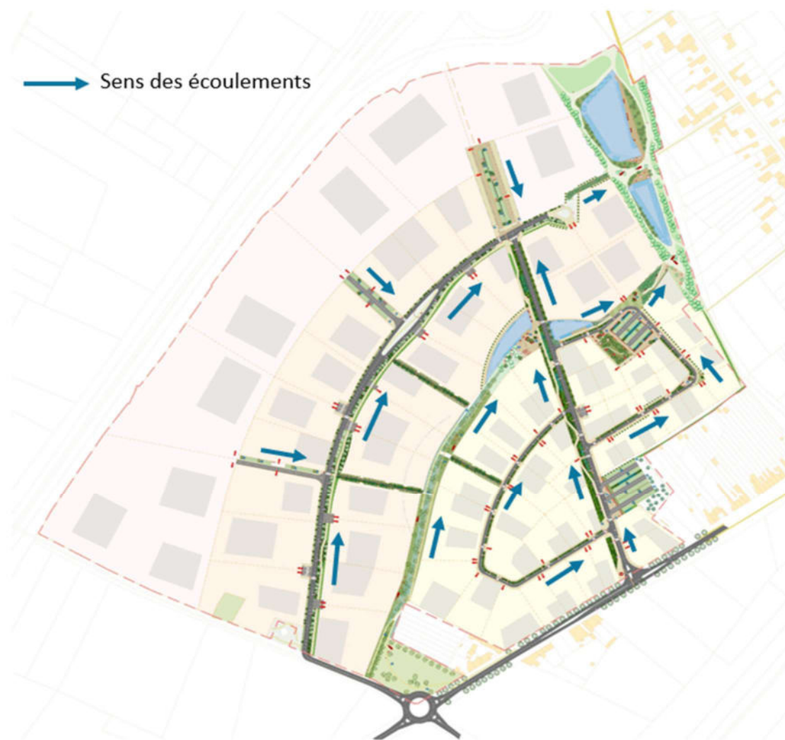
Figure 1 : Schéma de principe des écoulements des eaux pluviales
